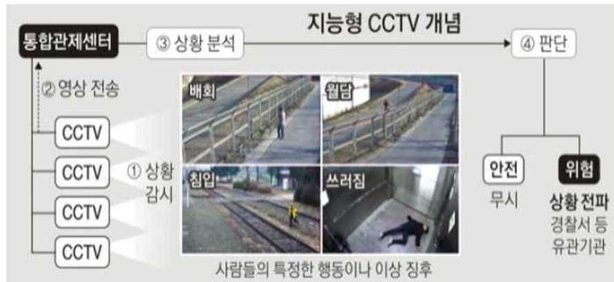
그림 60 CCTV (지능형) 예시도
