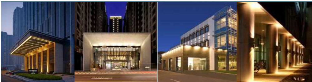
출입구의 형태를 고려하여 지중등, 간접등 등의 조명연출로 입구부 인성성을 부각 시키도록 함 색온도 3000K~4000K
