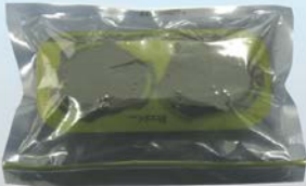
3 측정완료 후 정전기방지 지퍼백에 넣어 실험실로 이송
