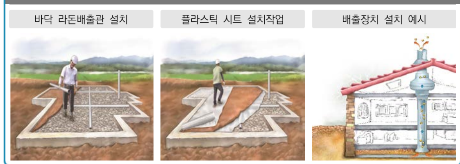
신축 주택 토양라돈 배출장치 설치 예시
