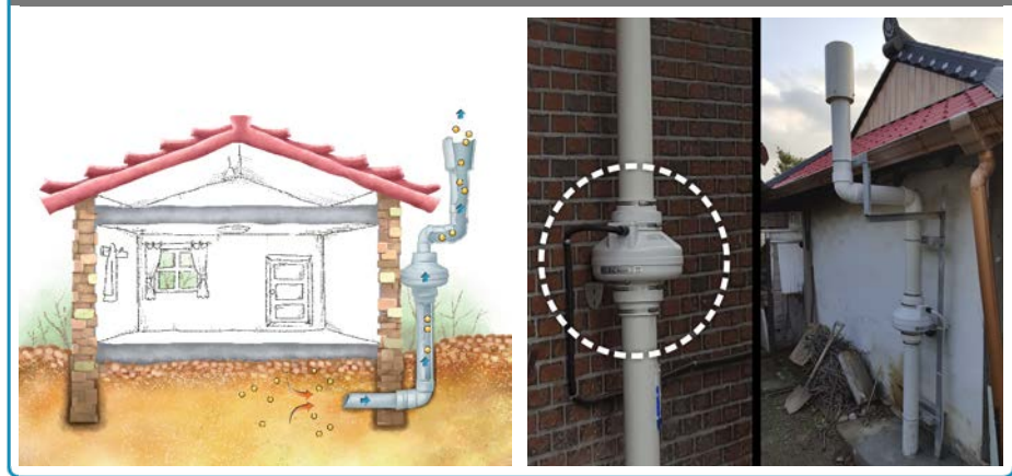
기존 주택 토양라돈 배출장치 설치 예시
